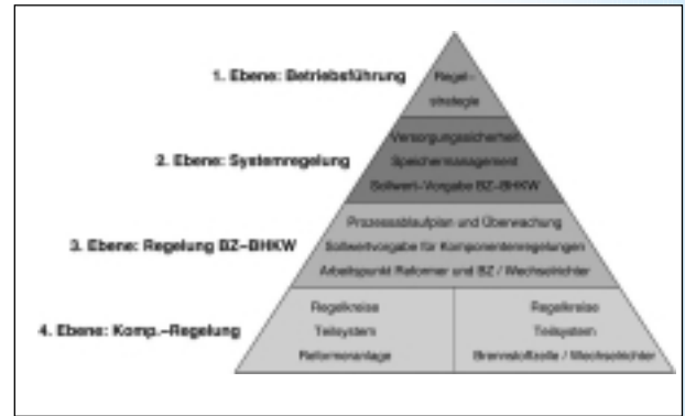
Abbildung 3: Regelungshierarchie des Energieversorgungssystems auf Basis eines erdgasbetriebenen Brennstoffzellen-Blockheizkraftwerkes und eines Schichtspeichers mit integriertem Gasbrenner (vgl. [1]). Figure 3: Control concept of an energy supply system based on a residential fuel cell cogeneration plant and a stratified storage with an internal gas burner [1].
